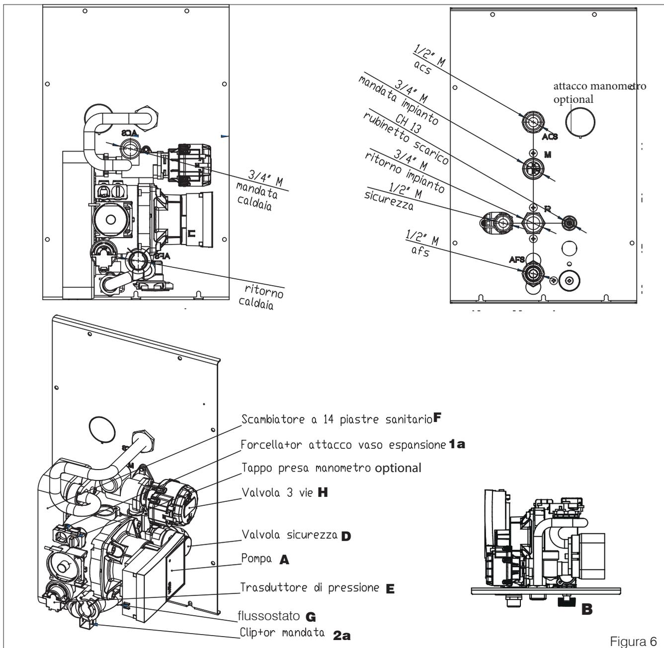
Kit installato sulla termostufa (le figure 7 e 8 mostrano il risultato delle operazioni di montaggio descritte nel paragrafo "Montaggio dei Kit").
